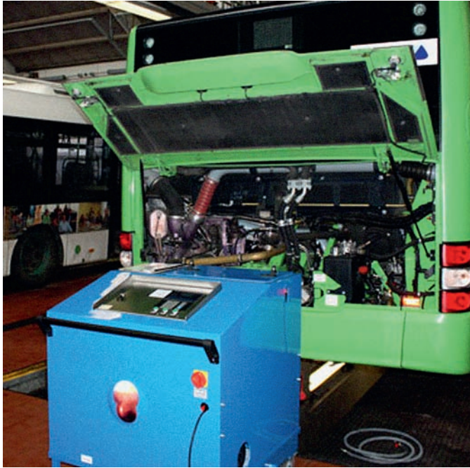
Motorenöl: Ein Dialysegerät (blau) reinigt das Öl – der klassische Ölwechsel wird überflüssig
